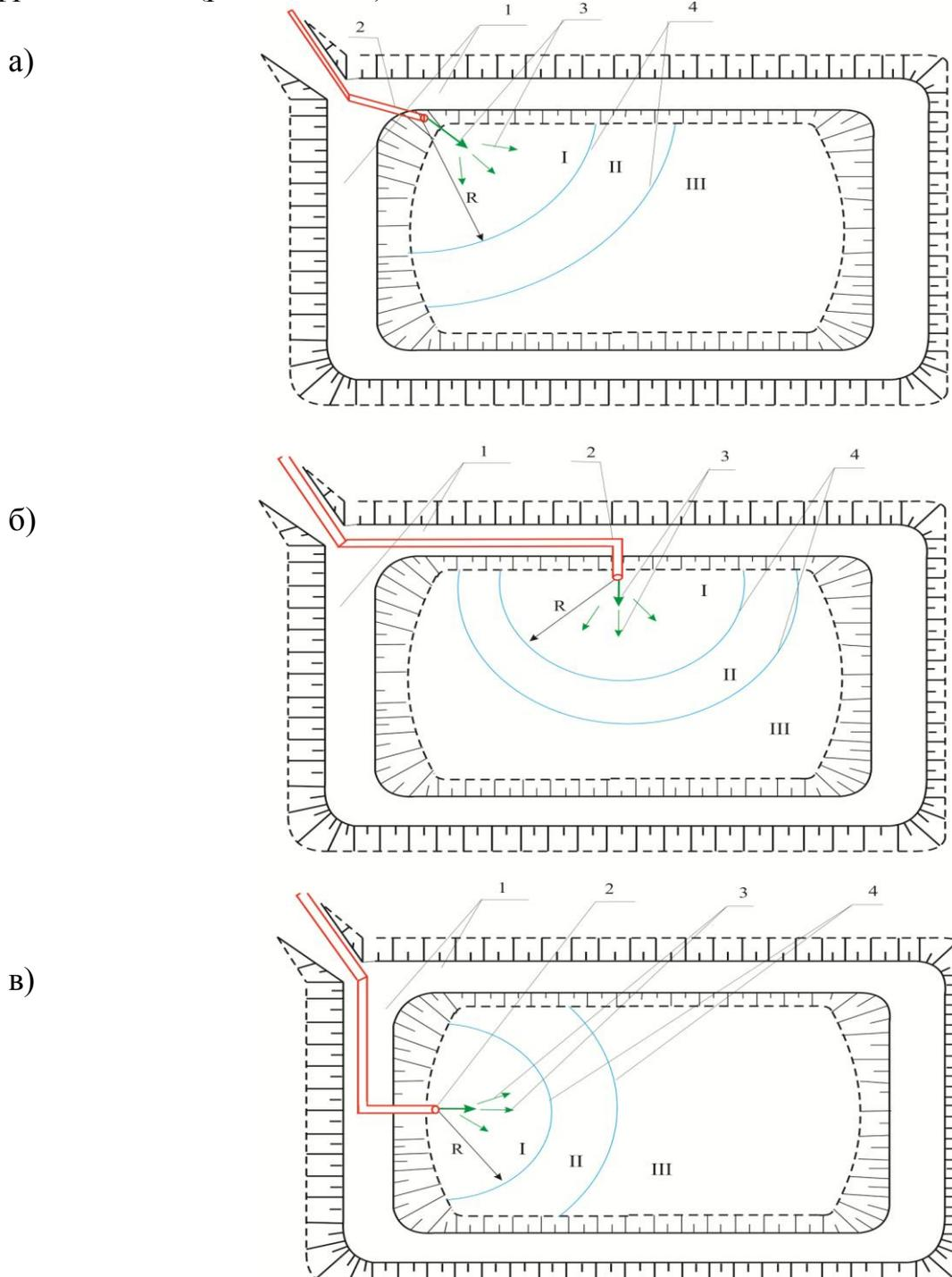
1 – дамба; 2 – выпуск пульпы; 3 - течение потока пульпы; 4 – границы зон сортировки минерального сырья по крупности: I - крупные частицы; II – средние частицы; III – мелкие и пылеватые частицы;  $R$  - дальность перемещения частиц каждого класса
