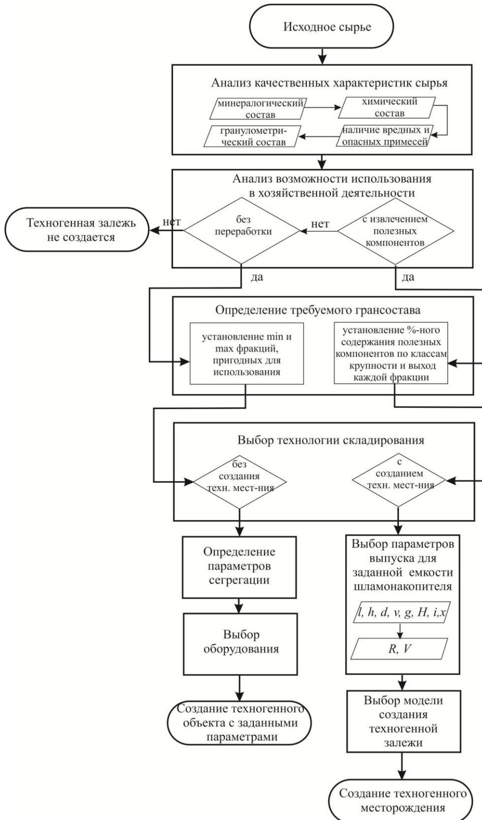
Рисунок 3 – Блок-схема методики формирования техногенной залежи
